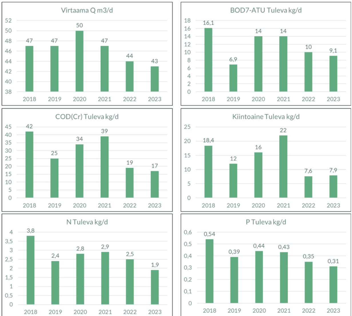
Kuvat 2-7. Puhdistamon viemärikuormituksen vaihtelu vuosina 2018-2023
